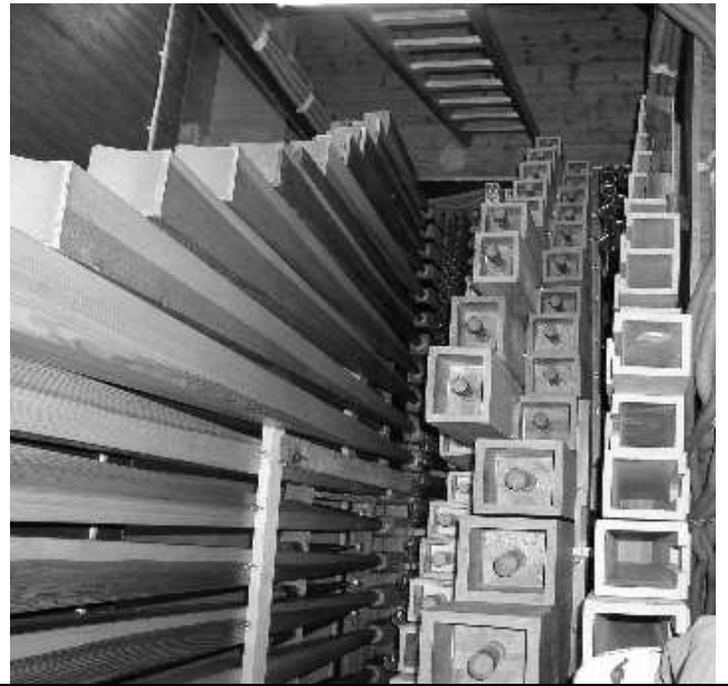
Bild008 Schwellwerkwindlade mit Pfeifen, von rechts aus : Clairon 4', Oboe 8', Basson 16', Salizional 8', Koppelflöte 8', Gemshorn 4', Vox coelestis 8'
