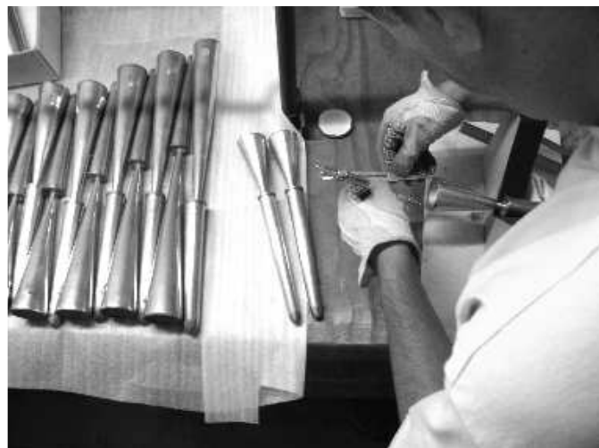
Bild012 Arbeit mit dem Reduktionszirkel an den Bechern des Clairon 4'
