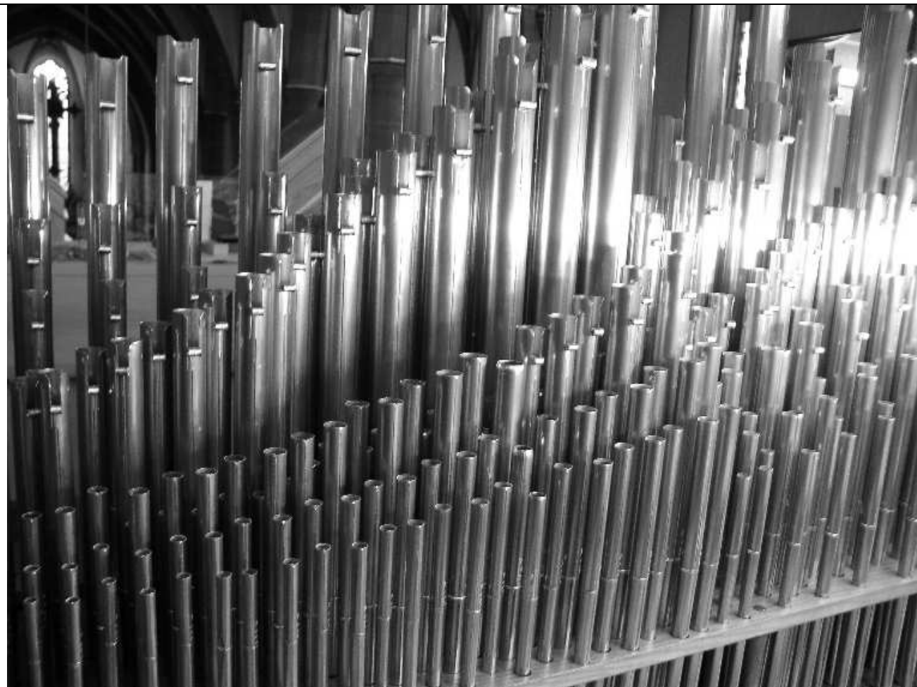
Bild009 Pfeifen des Plein jeu 4-5fach im Schwellwerk
