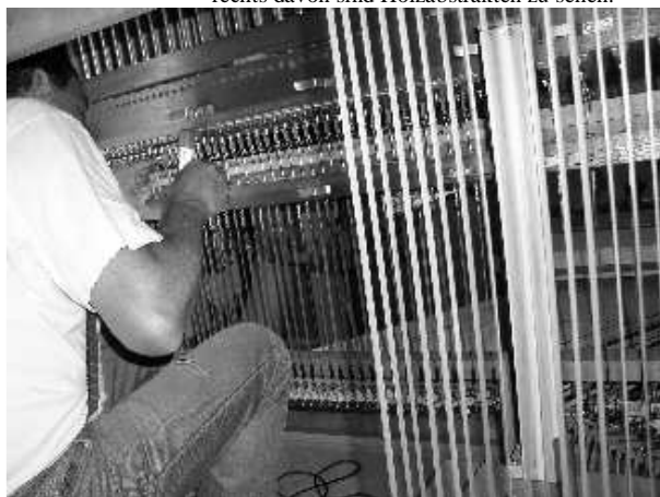
Bild011 Arbeit an der Schwellwerkwindlade, die geöffnet ist, und wo die Ventile zu sehen sind. Darunter und rechts davon sind Holzabstrakten zu sehen.
