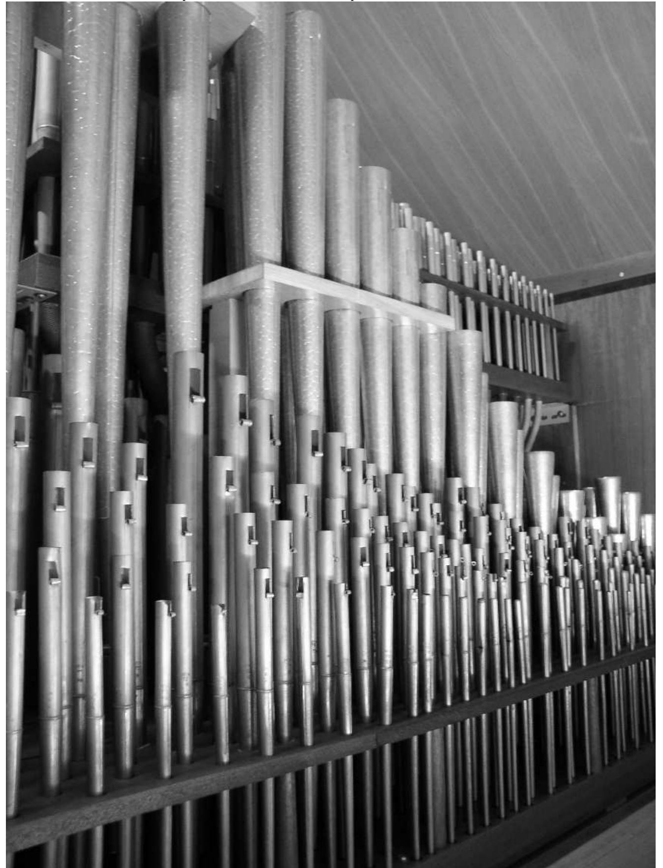
Bild010 Pfeifen des Hauptwerk, vorne Mixtur und Trompete, oben Cornett 5 fach
